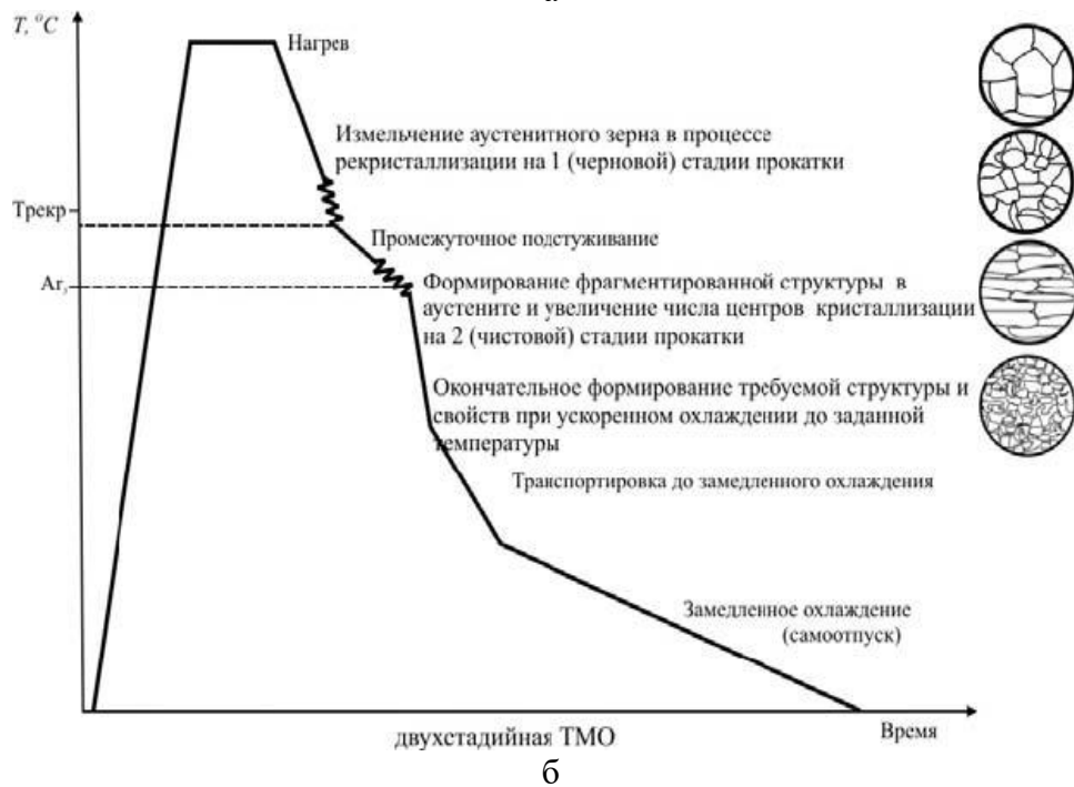
Рисунок А.1 – Технологические схемы ТМО+УО для изготовления листового проката из хладостойких судостроительных сталей категорий D, E, F марганцевой (а) и марганцево-никелевой (б) композиции легирования [86-88]
