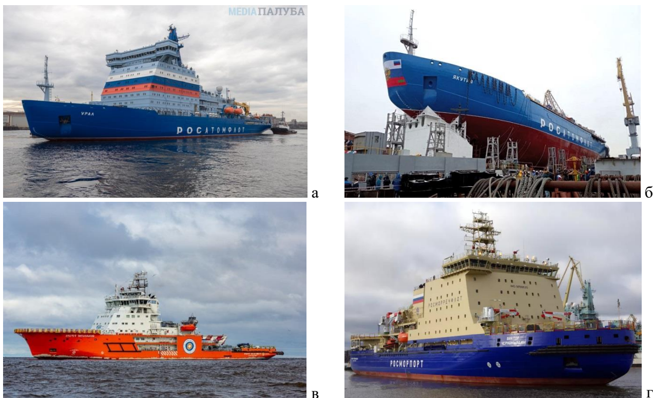
Рисунок 8.1 – Крупнейшие в мире универсальные атомные ледоколы «Урал» (а) и «Якутия» (б) проекта 22220. Ледокольное судно обеспечения проекта Aker ARC 130 А (в).
