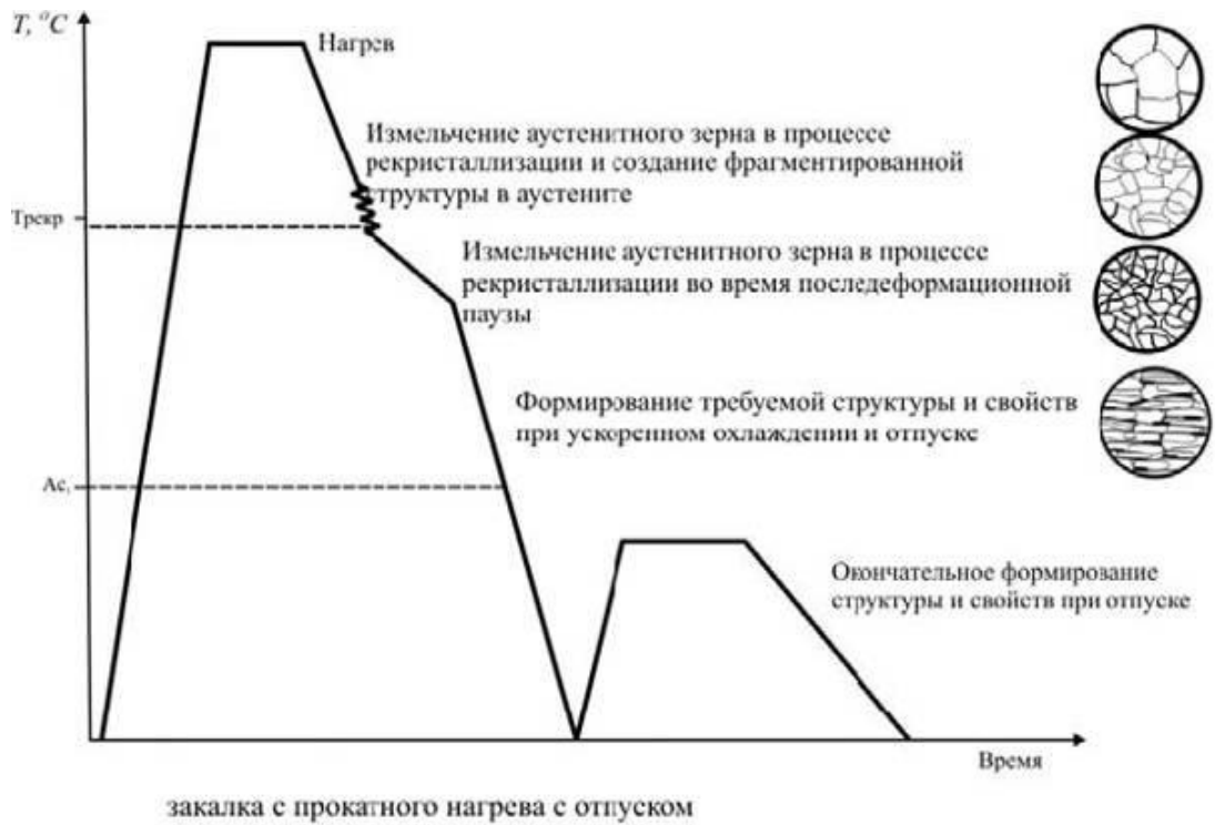
Рисунок А.2 – Технологическая схема закалки с прокатного нагрева с высокотемпературным отпуском для изготовления листового проката из хладостойких судостроительных сталей категорий D, E, F хромникельмедьмолибденовой композиции легирования [86-88]
